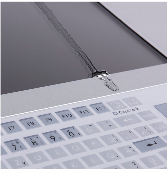
A15-KB - Front mit resistivem Touch und Folientastatur in IP65
